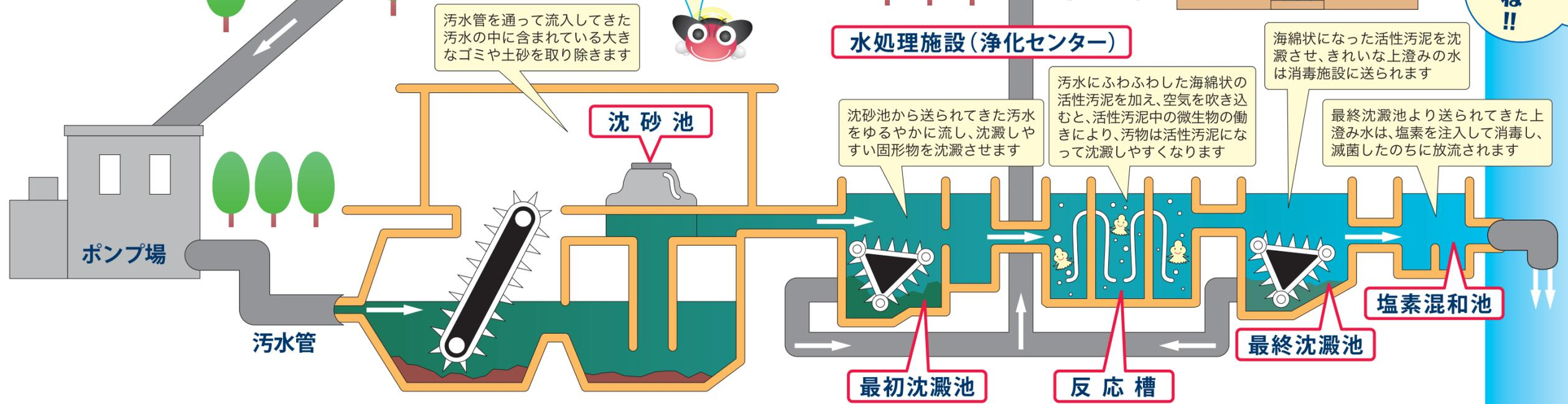
汚水管を通して流入してきた汚水の中に含まれている大きなゴミや土砂を取り除きます
