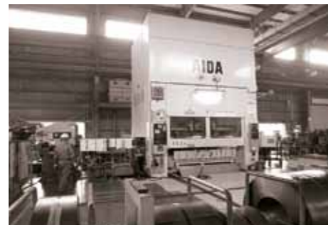
県内に6台しかないという500トンプレス機。さまざまな部品を作り出していくことができる最新の設備です。
